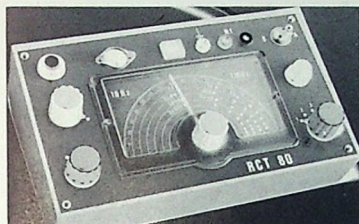
Bild 1. Ansicht des RC-Generators im pultförmigen Teko-Gehäuse
