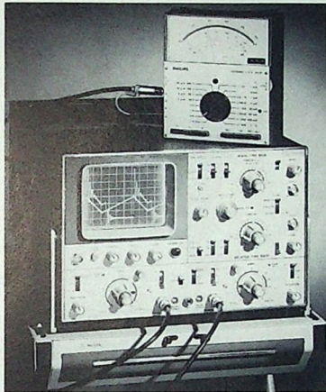
Bild 1 (oben). Multiplizierender Elektronenstrahl-Oszillograf „PM 3252“ mit angeschlossenem elektronischen Multimeter
