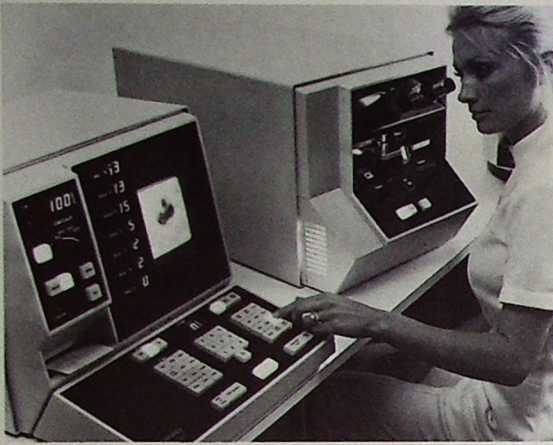
Bild 3. Meßplatz (Mikroskop mit Scanning-Einrichtung, Display mit prozentualer Ziffernanzeige, Hilfsgerät zur Herstellung des Blutaustriebs und Rechner) zur Unterscheidung von sechs verschiedenen Arten von weißen Blutkörperchen (Leukozyten); rechts: Mikroskop mit vom Rechner gesteuerter Objektträgerbewegung; links: Bedienungsteil mit Schirmbilddarstellung des mikroskopischen Gesichtsfeldes, prozentualer Anzeige der verschiedenen Zelltypen und Einrichtung zum Ausdrucken der Meßergebnisse. Der Rechner „PDP-8“ befindet sich nicht sichtbar unterhalb der Tischplatte („LARC-Analyzer“ des Biomedical Technical Center of Corning Glass Works, Raleigh, N.C.)
